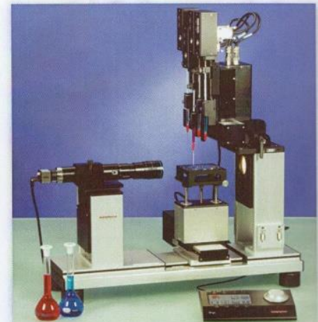
OCA200 配备 4 直接电动注射系统 DDE/4 和 4 个电控注射单元 ESr-N
